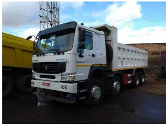
【写真2】 既存収集車両で主に稼働しているダンプトラック。ごみは人の手で荷台に直接積上げられている。（2021年3月）
