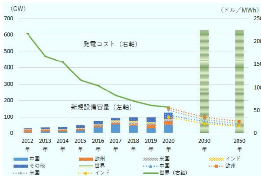
図 3-1.8 太陽光の新規設備容量と発電コスト
