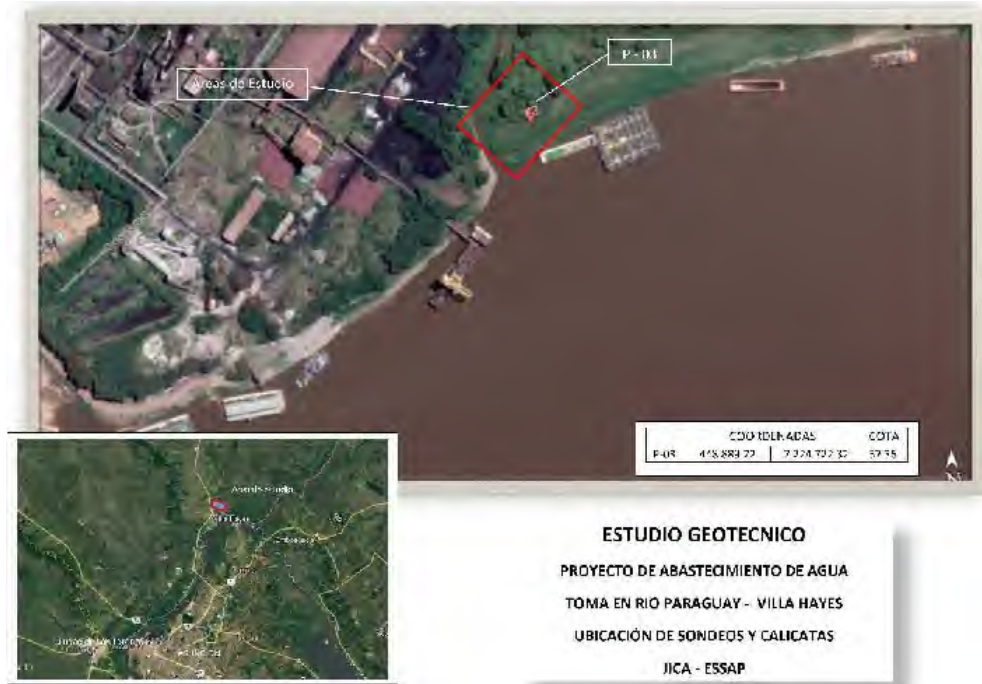
図 6.2.11 地質調査(ボーリング)実施位置(取水施設①)
