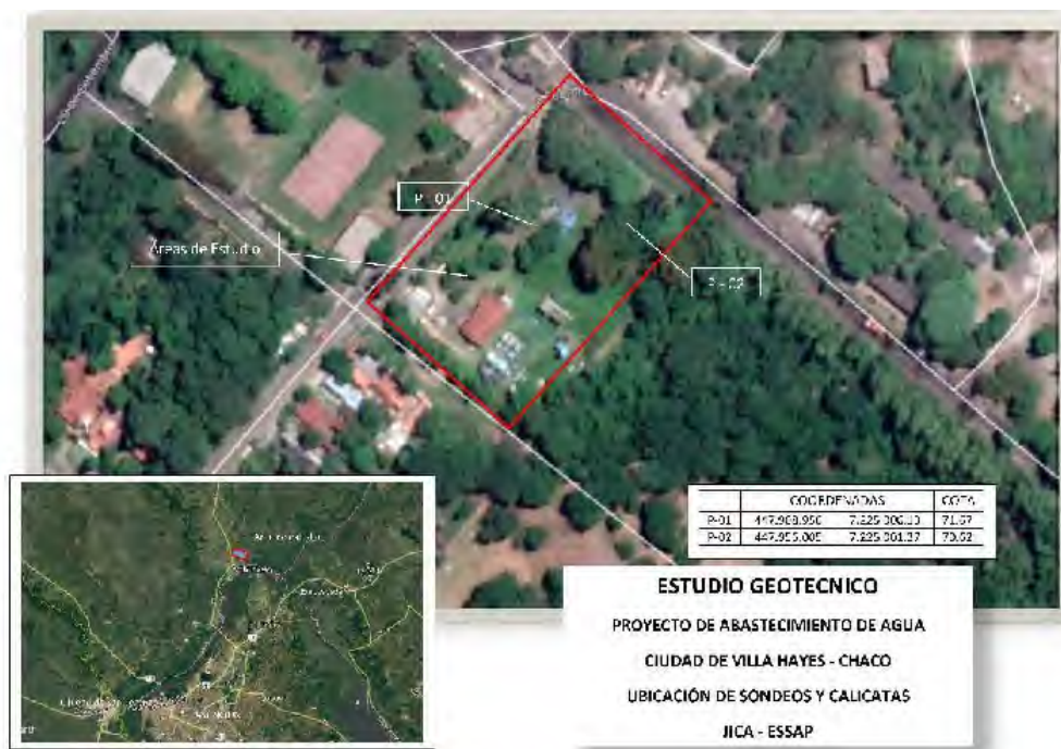
図 6.2.8 地質調査(ボーリング)実施位置(浄水場)
