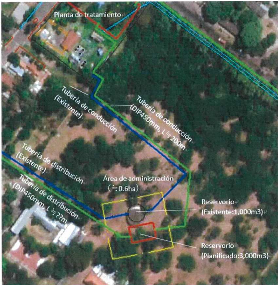
Figura 3: Reservorio de agua tratada y tubería de conducción
