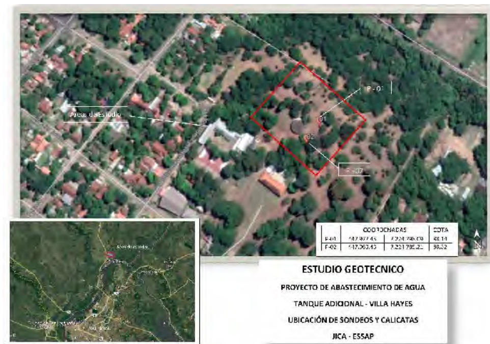
図 6.2.19 地質調査(ボーリング)実施位置(配水池)
