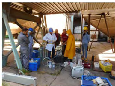
Foto 3-9 Prikaz sa merenje izduvnih gasova u TE Kosovo B
