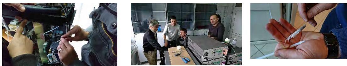
Foto 3-15 Rehabilitacija analizatora i čišćenje cevi za uzorkovanje (cevi od teflona)
