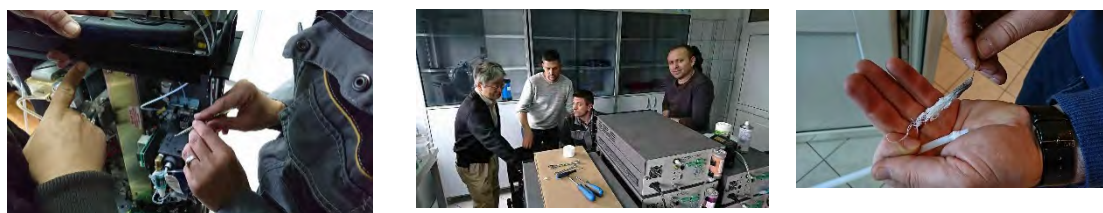
Foto 3-15 Rehabilitimi i analizatorëve dhe pastrimi i tubit të mostrimit (tubi nga Tefloni)
