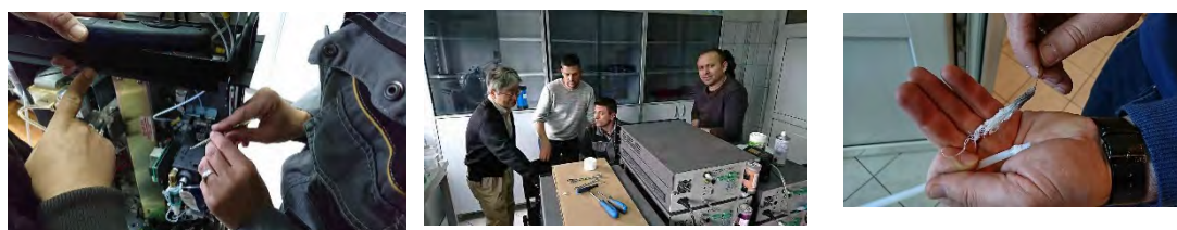
写真 3-15 リハビリテーションと試料大気導入管のクリーニング
