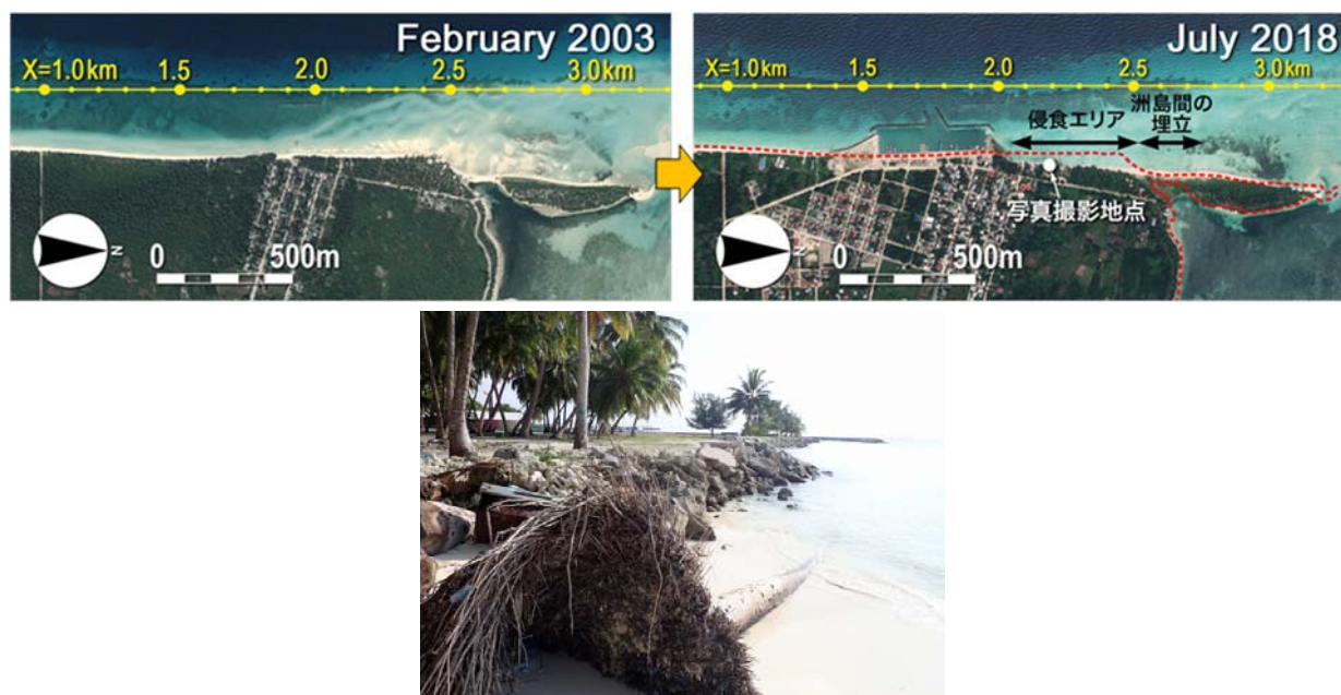
図 6.4.8 港建設前後の汀線変化と下手側の海岸の様子
