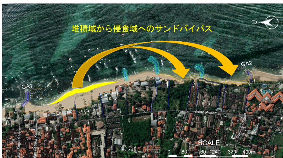
図 4.3.7 モニタリング結果を踏まえたサンドバイパスの計画イメージ
