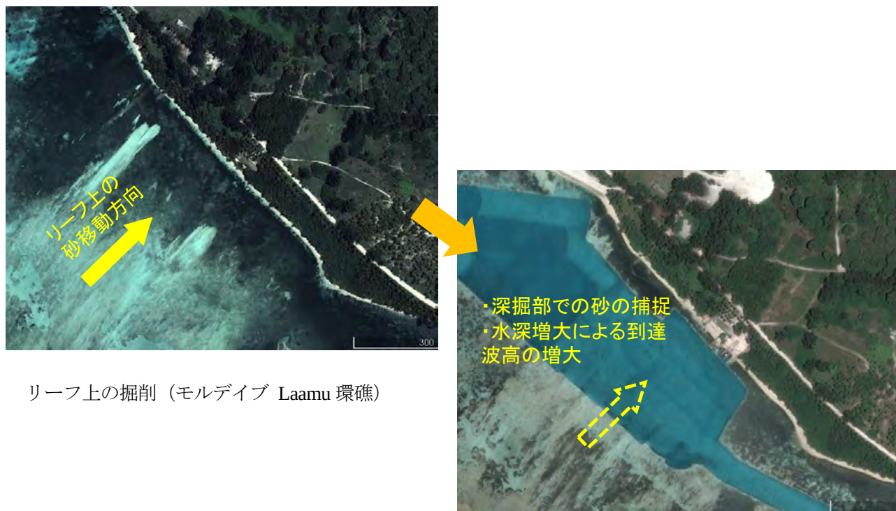
図 2.1.5 ケース 5：リーフ上でのインフラ施設構築による沖側からの漂砂移動阻止に伴う海岸侵食 (モルディブ国 Laamu 環礁の事例)
