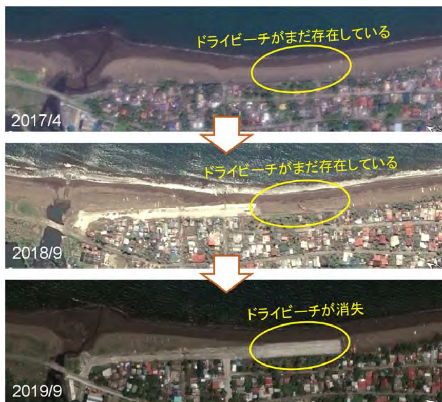
図 2.1.6 ケース 6：前浜上での護岸構築およびそれによる海岸侵食の助長 (フィリピン国での事例)
