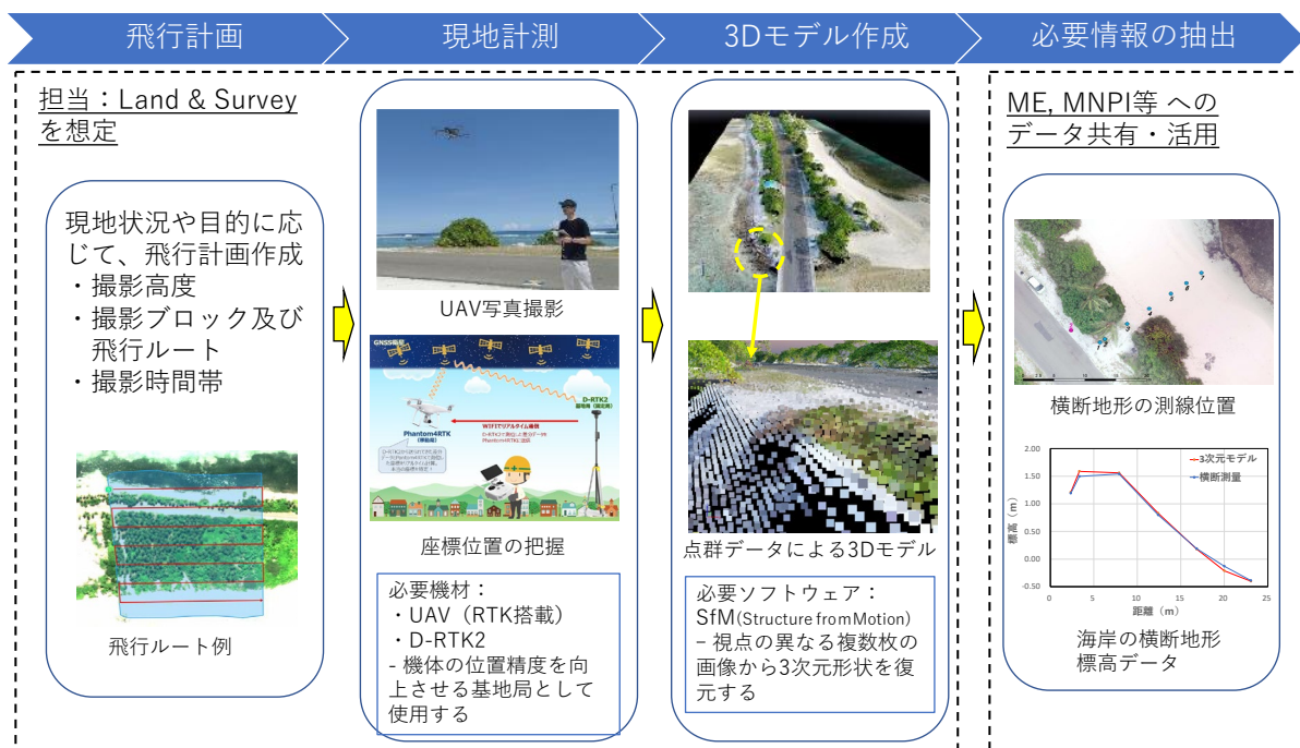
図 8.5.3 UAVによる海岸・リーフモニタリングシステムのイメージ
