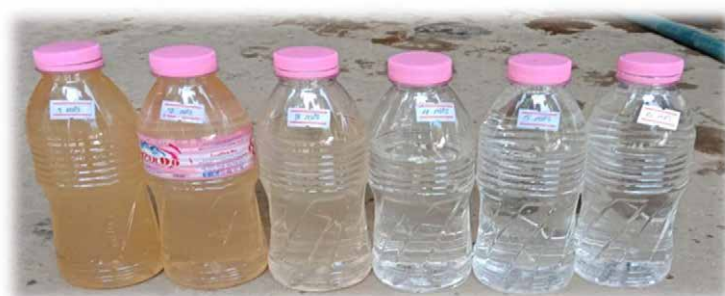
写真 2-83 : 洗浄排水の外観
