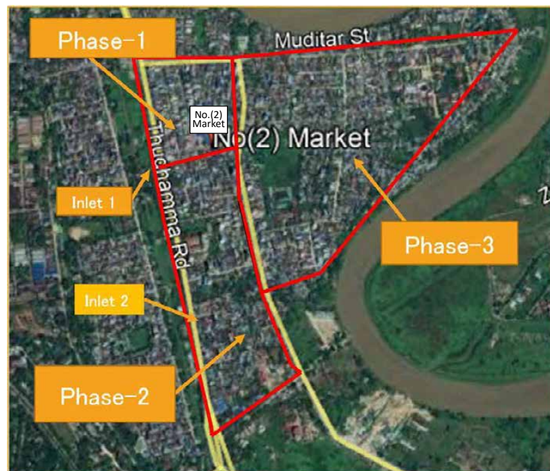
図 2-64：DMA の構築 Phase と各 Phase (DMA) の流入箇所(計画)
