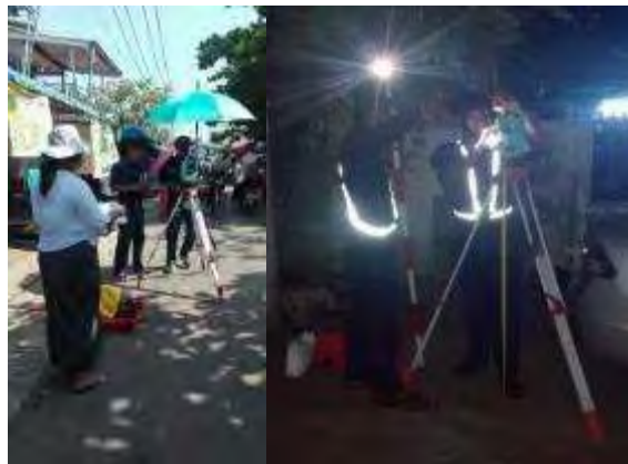
写真 2-45：トータルステーションを用いた現地測量
