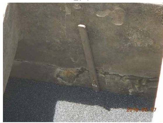
新たに投入されたアンスラサイト (Phase1 パイロットろ過池)
