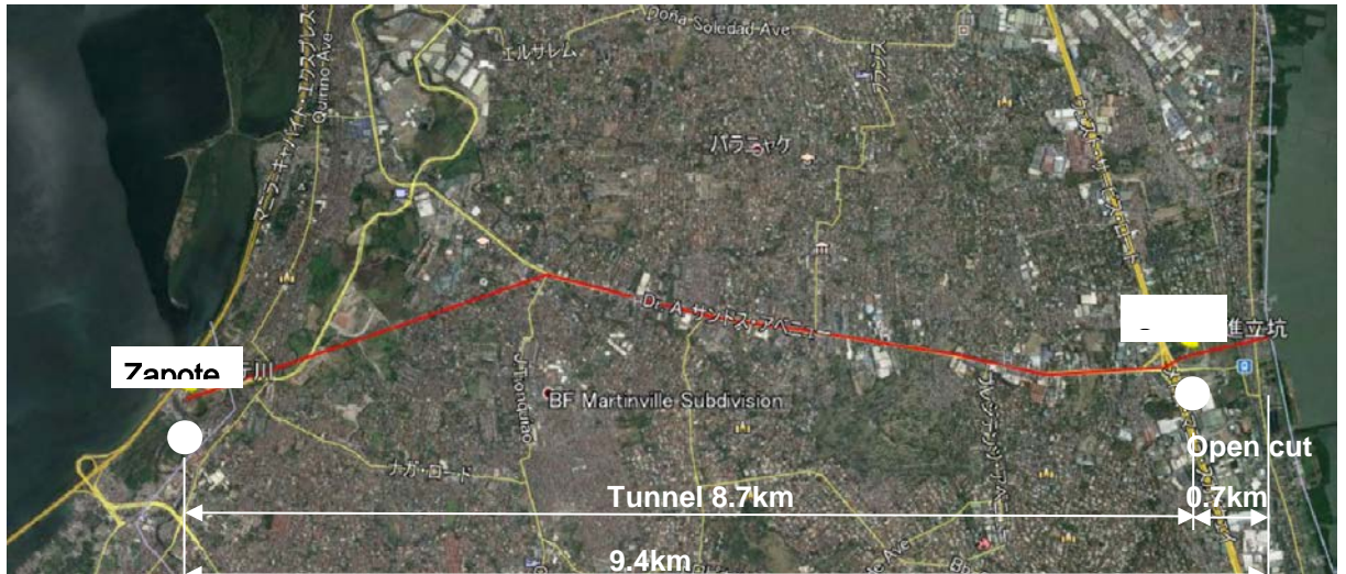
図 4.2.12 トンネル計画平面図 ルート 2-B (Zapote 到達ルート案)
