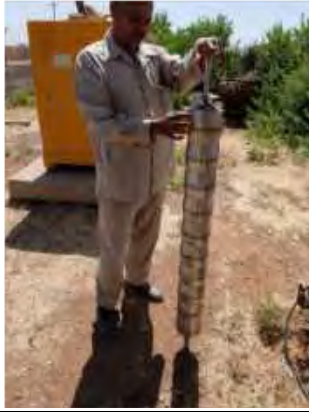
写真-19：メンテナンス中の水中ポンプ（調達対象）（ハワタ・ワドエラガエイリ地区）。
