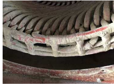
写真- 8 シルトのモータ内部付着
