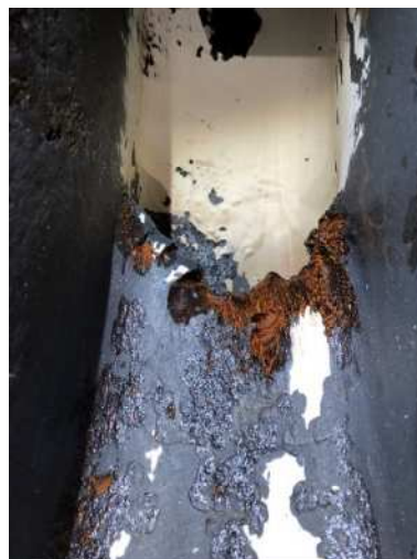
写真- 5 ケーシング舌部の損傷
