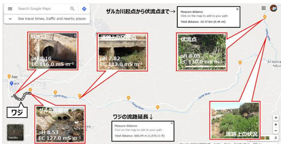
図 2. ザイ浄水場から流出する汚泥水のトラッキング結果（調査日：2019 年 7 月 23 日）
