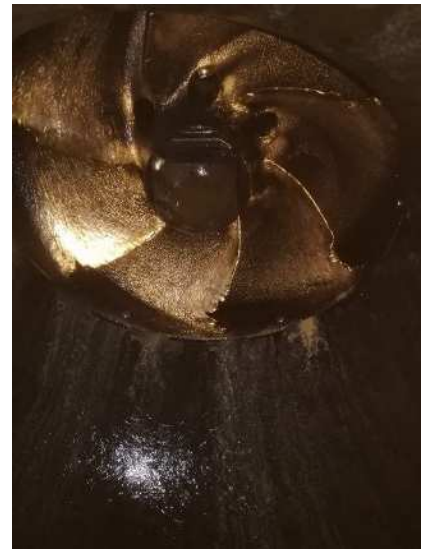
写真- 3 インペラの欠損
