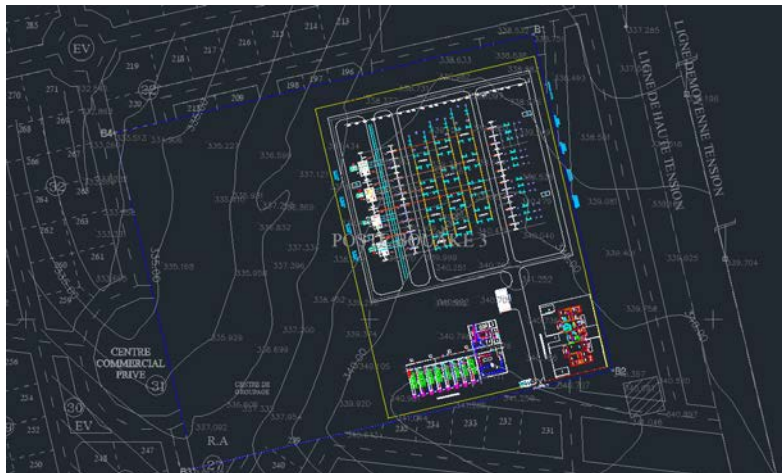
図 6.3-2 Bouaké 3 変電所 変電所タイプ検討図
