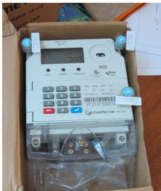
図 4.3-8 スマートメーター
