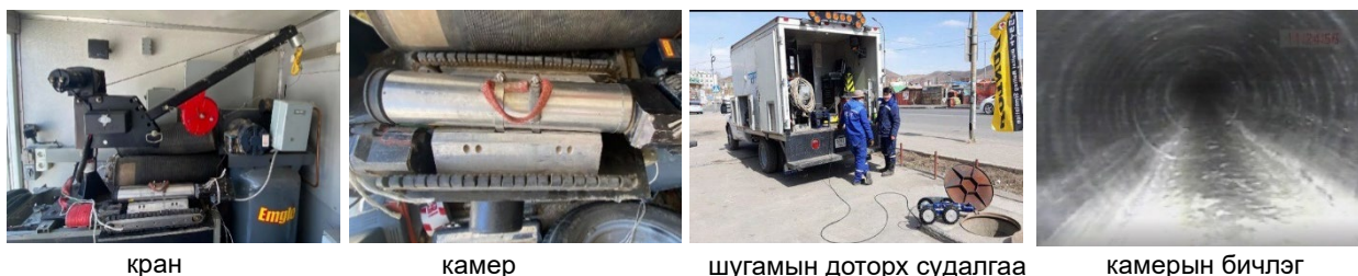
Гэрэл зураг 2.3 Шугамын хоолойн засвар үйлчилгээний тоног төхөөрөмж, судалгааны байдал
