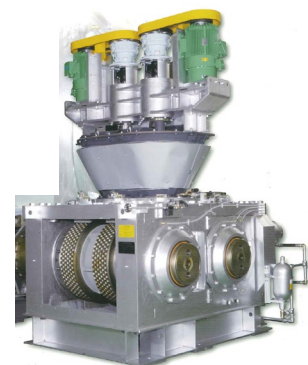
Зураг 3.2 Өндөр даралтын брикетны машин
