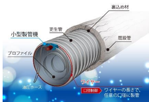
図 3.10 SPR 工法(自走式)
