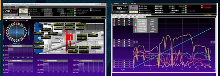
シールドマシンの掘進管理
