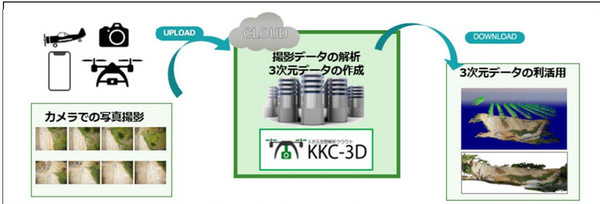
KKC-3D を利用した SfM (Structure from Motion) 処理の流れ
