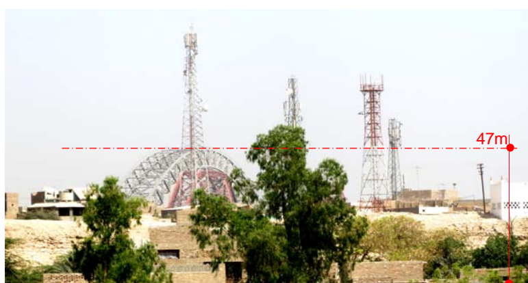
PMD ローリ・サッカル気象観測所より地盤が4m高い+ランスドン橋の高さ43m=47m +1mのクリアランス=48m
