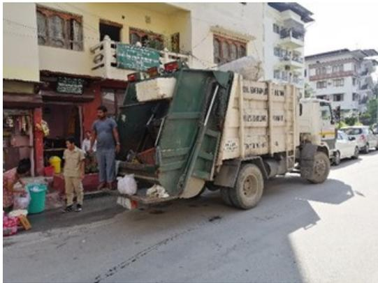
インド製のコンパクターによる廃棄物収集の様子。浸出水を垂れ流しながら街中の廃棄物を収集している。(2019年10月)
