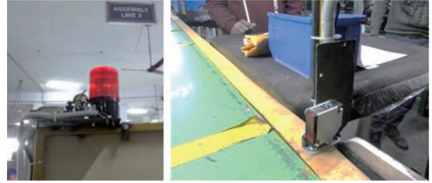
図20 ライン停止スイッチで点灯するパトライト
