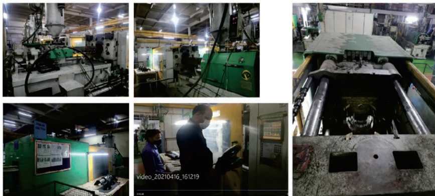
図 50 対象機械 (450 トンの大型プラスチック射出成型機)
