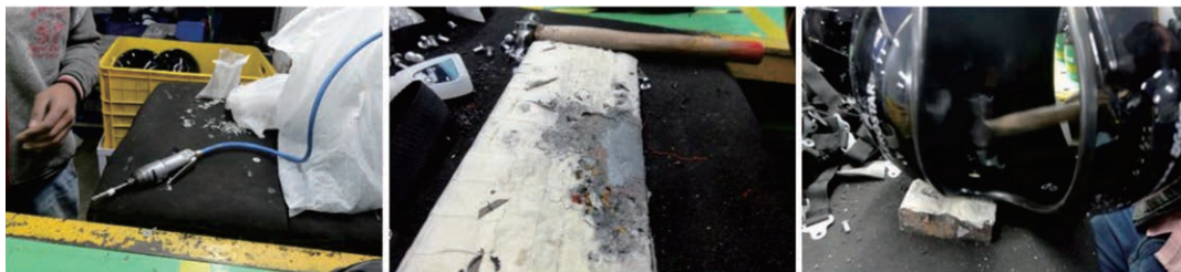
図22 キズ、凹み等の発生恐れがある作業、工具、作業台などを指摘
