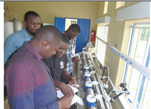
水道メータの動作・性能検査 2020年2月
