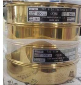
A figura 4, mostra o processo de separação granulométrica. Neste caso, usa se crivos de 300 a 500  $\mu\text{m}$ . O que passa para o último crivo vai ser usado para outras análise (ex: XRD) O material que passa no crivo de 350  $\mu\text{m}$  é para a separação do zircão. O que restar no primeiro volta a ser esmagada até completar toda a amostra.
