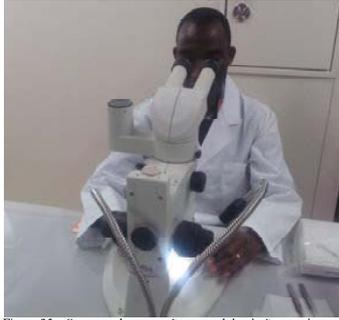
Com uma agulha e com a ajuda da ampliação do microscópio faz-se a separação do zircão. Preparar uma lâmina, colocar a cola apropriada para garantir que o zircão permaneça no vidro. Colocar o zircão no vidro de forma vertical e na mesma zona.
