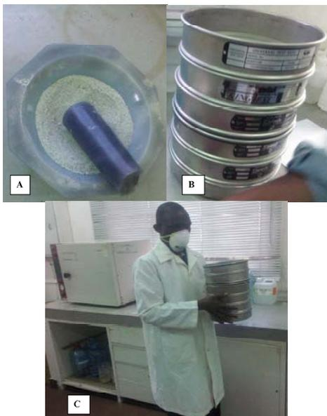
Figura 02 – Trituração e crivagem. A: Almofariz, B: sene de crivos e C: processo de separação granulométrica.
