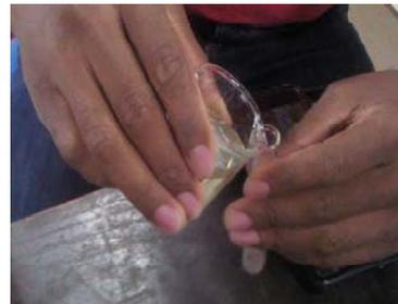
Introduzir o líquido pesado (solução de politungostato de sódio) no tubo de ensaio contendo a amostra, até quase 75% de volume.
