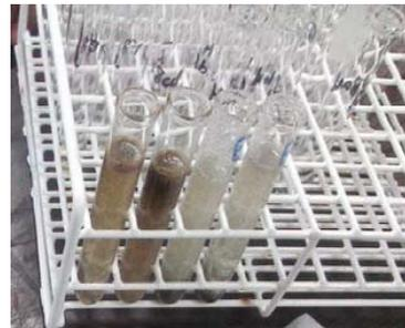
A figura 16, mostra os tubos de ensaio com amostra. O material mais denso, acima da densidade de 3.0 g/L, deposita-se no fundo do tubo e o material leve flutua.
