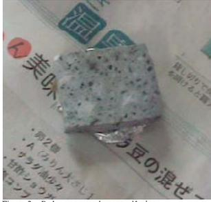
Pedaco da amostra cortada nas dimensões apropriadas para se fazer lâminas delgadas.
