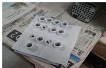
3.2 As secções polidas foram colocadas e levadas para o Excicador a bomba vácuo para absorção das bolhas existentes nos fracos com a resina.após 10 minutos são retiradas for a do aperelho. e das capsulas.
