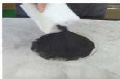
Fig.12: Ilustra papel  $A_2$  para colocar amostra. Fig.13: Ilustra a homogeneização da amostra.
