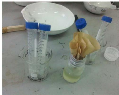
Figura 16 – Processo de recuperação do politungostato de sódio
