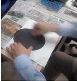
Nota: Sempre que se mudar de um abrasivo para o outro é preciso colocar no ultrassônico por 10 minutos para garantir a limpeza.
