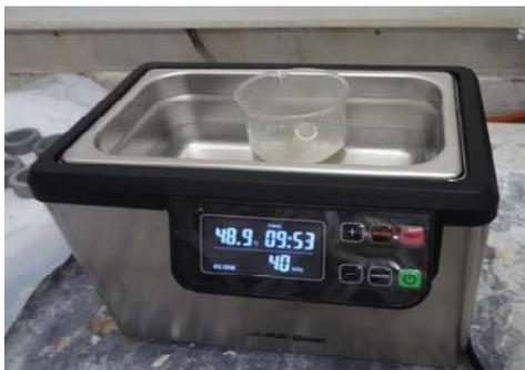
Figura 32 – Processo ultra-sônico - Se aparecer uma coloração esverdeada, é suposto a existência do ferro e por conseguinte, chlorite.
