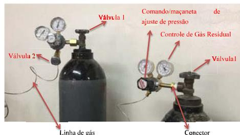
Fig. 1: Ilustra o cilindro de gás (Nitrogênio e Oxigênio).
