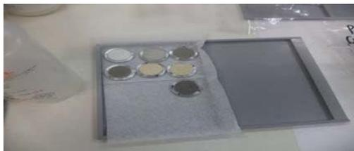
Figura 11 – Compartimento para colocar amostras
