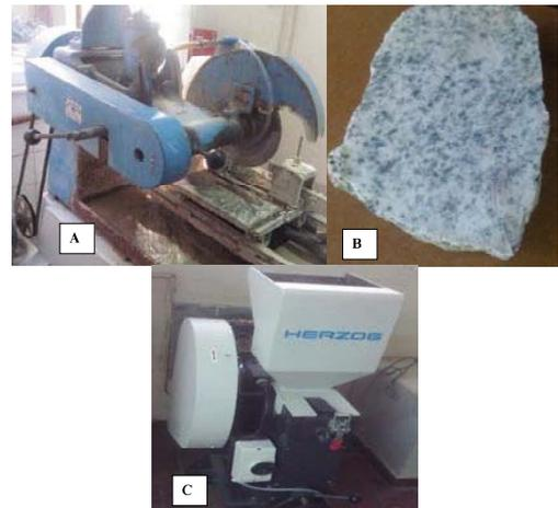
Figura 01 – Preparação da amostra. A: máquina de corte, B: amostra de granito e C: Britadeira
