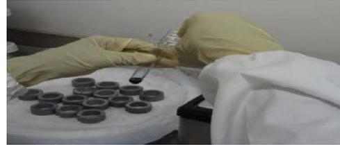
Figura 31 – Introdução do ácido no tubo de ensaio com amostra
