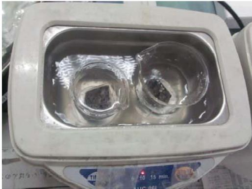
Figura 11 – Banho ultrassônico com laminas para limpeza durante 15 minutos
