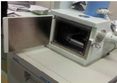
Figura 34 – Compartimento com amostra para a leitura
