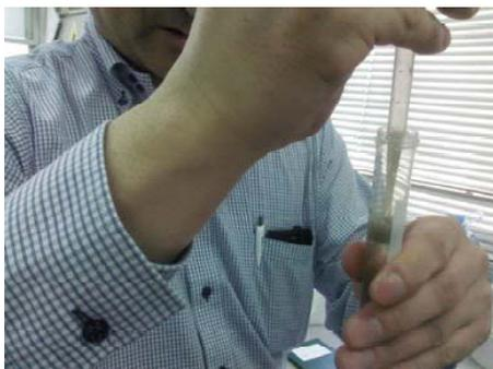
Figura 14 – Retirada da parte flutuante (suja)
