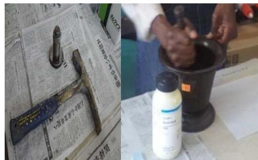
Figura 05 - Suporte para a prensagem manual, martelo e moedor tipo pilão – Esmagar a amostra dura até se obter um pó com granulometria desejada, usando crivos.
