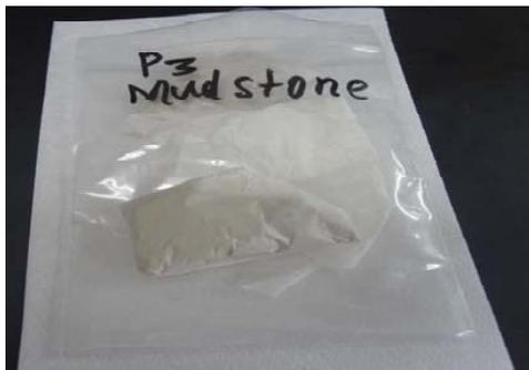
Figura 07 – Colocação da amostra no plástico - A amostra deve ser colocada dentro do plástiquinho e colocar sua identificação.
