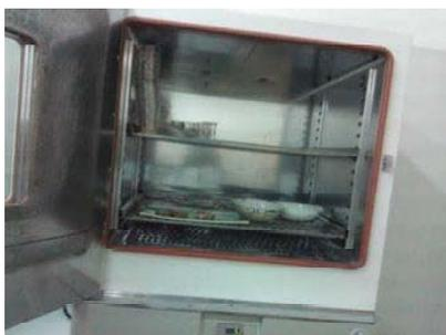
Figura 20 – Secagem da amostra na estufa
