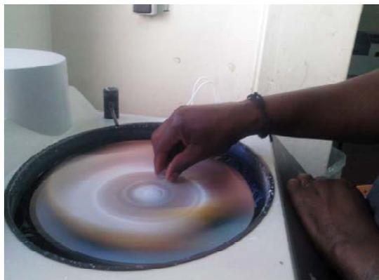
Figura 27 – Processo de polimento na máquina, usando alumina
