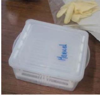
Usando luvas, retirar as amostras na estufa e colocar no dessicador, evitando poeiras e humidade.
