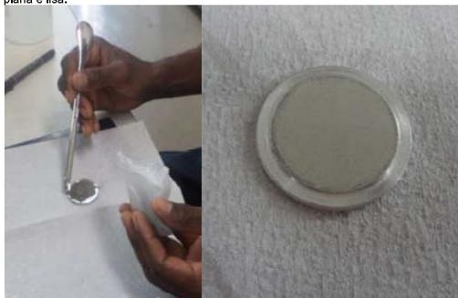
Figura 10 – Preparação da amostra para XRD
