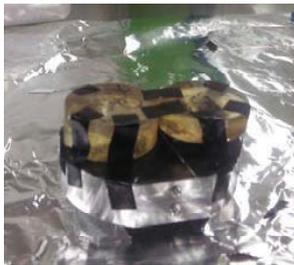
A amostra é recoberta com iões metálicos de ouro (Au), ligas de ouro/paládio (Au-Pa) ou ainda platina (Pt), para que as amostras sejam condutoras, pois caso não funcionaria como fio terra que no lugar de reflectir os electrões estaria como passagem delas, o que não é desejável. Deve-se tomar muito cuidado no uso deste aparelho, somente pessoas especializadas devem o fazer, por causa da sensibilidade do aparelho.
