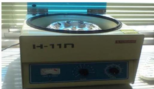
Figura 16 – Centrifugador com amostra
