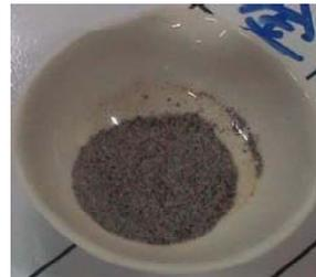
Depois de 24 horas a amostra é retirada da estufa para procedimentos posteriores.
