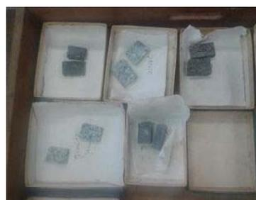
2.3-Desgaste e polimento das laminas delgadas com os #150,#320 e #800 respectivamente
