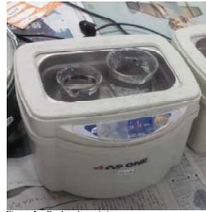
Ultrassônico no processo de limpeza depois de cada abrasivo.
