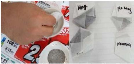
Figura 3: Processo de separação de minerais magnéticos dos minerais não magnéticos usando íman.
