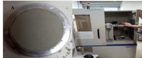
Figura 14: A) Amostra para a difracção de raios X; B) Difratómetro de raios X.
