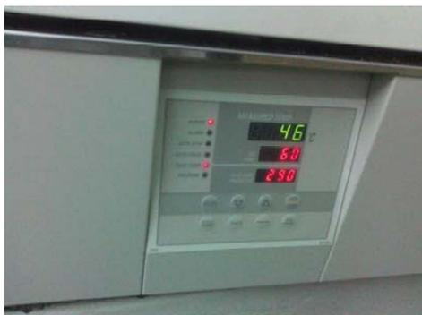
Figura 04 – Estufa com amostra, no processo de secagem
