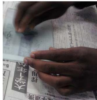
Usando abrasivos de 800 mesh limar as arestas da laminula. Com abrasivo de 3000 mesh, limar suavemente a base com cuidado de não atingir as amostras do zircão. Este procedimento é feito usando abrasivo em pó num vidro para cada tipo.
