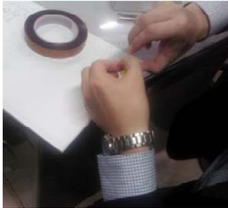
Colocar a fita cola na lâmina com muito cuidado, evitando criar bolhas de ar, pois estes podem aparecer em posterior análises, perturbando a informação. Depois de colar, retira a parte de cima.
