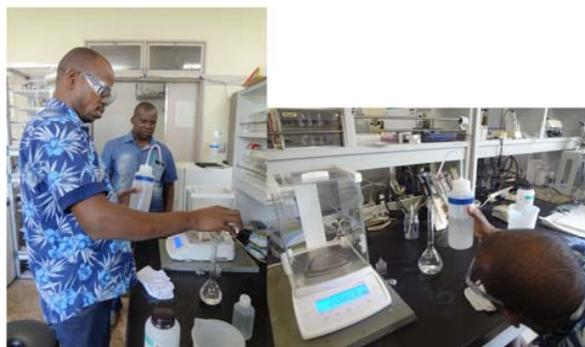
Figura 20. Preparação da amostra padrão de titulação (EDTA, KOH, EBT e HSNN)
