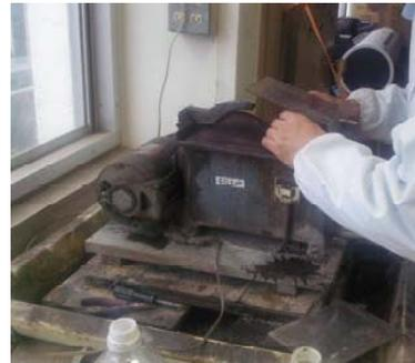
Processo de corte da amostra para lâminas delgadas. Corta-se um pedaço de aproximadamente 0,5 cm.
