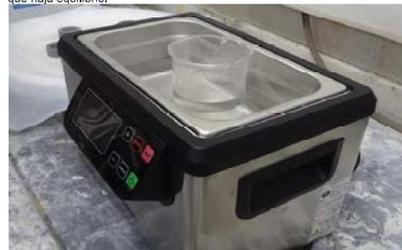
Figura 26 – Banho ultra-som com água a 80 °C e copo no se interior
