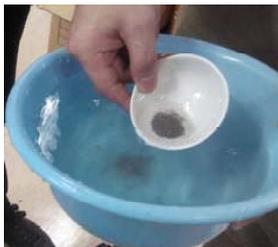
A figura 6, mostra o processo de separação via húmida. Neste caso, a separação consiste no seguinte: Numa bacia com água, introduzir a tina com amostras, inclinar a tina num ângulo que permita com que ao fazer se um movimento rotativo o material leve saia da tina. Numa outra tina, colocar o material denso.
