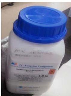
Figura 07 - Frasco contendo Politungostato de sódio para a preparação da solução com densidade aproximada de 3.0 g/L.
