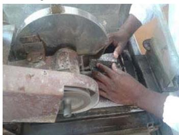
Fig.2 Corte com Serra diamante
