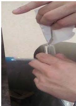
Colocar a amostra não magnética para um tubo de ensaio, previamente limpo e desinfetado com álcool etílico.
