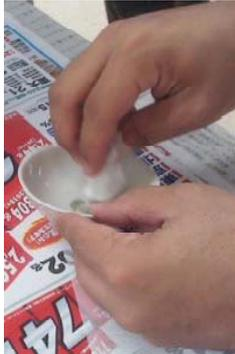
A figura 9 mostra o processo da separação magnética da amostra, usando o íman. Embrulha-se o íman em dois papéis de limpeza. O primeiro serve para cobrir o íman e o segundo para assegurar a amostra com propriedades magnéticas. Numa tina de porcelana, coloca-se a amostra e aproxima-se o íman que vai atrair as amostras com propriedades magnéticas e os não magnéticos permanecem na tina. A figura 8 representa a amostra separada, magnética e não magnética.
