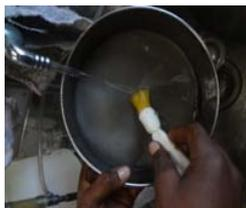
Fig.111: Indica a limpeza dos crivos Auxiliando-se com um pincel fino e leve.
