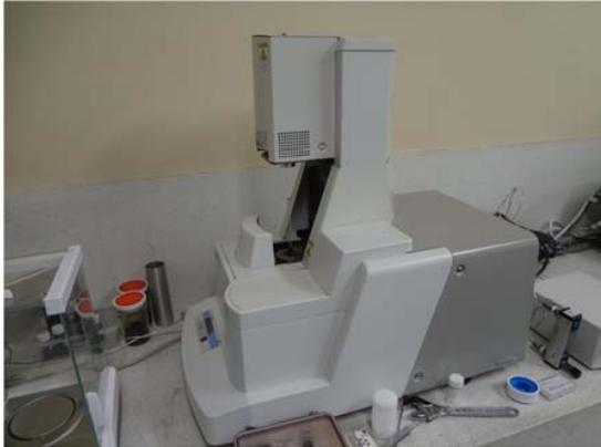
Medições Simultâneas de Termogravimetria e Análise Térmica Diferencial
