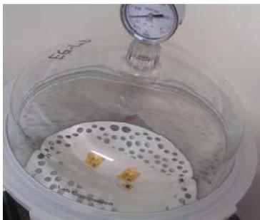
Usando o exsiccador de vácuo para garantir que todo o ar que possa existir dentro da amostra seja retirado.
