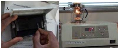
Figura 7: A) Preparação do carbono para "coating"; B) Máquina de "carbon coating" contendo amostras.
