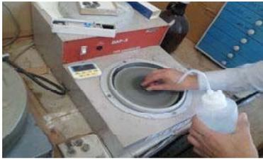
Fig.3 polimento da seccao com sulfureto e liquido lubrificante
