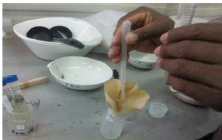
Figura 15 – Introdução do politungostato de sódio no frasco
