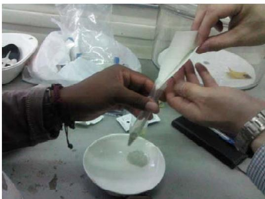
Figura 09 – Processo de introdução da amostra no tubo de ensaio
