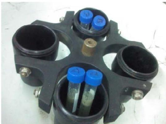
Figura 12 – Separação usando centrifugador
