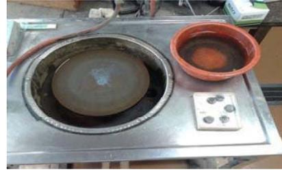
Fig.1 Máquina para desgaste e polimento #150,#320 e #800
