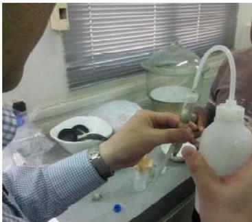
Figura 17 – Lavagem da amostra com água destilada
