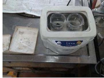
Fig.1 Máquina de limpeza da lâminas
