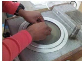
Colocar a pasta de diamante de 3  $\mu\text{m}$ , limar entre 7 a 15 minutos a uma rotação de 250 rpm. Lavar por 5 minutos no ultrassónicos e limpar com álcool etílico. Fazer o mesmo processo para 1 e 0,25  $\mu\text{m}$ . Antes de passar para um outro abrasivo deve se passar pelo microscópio para ter a certeza do passo a seguir. Colocar as laminulas na estufa durante 1 dia a 60°C.
