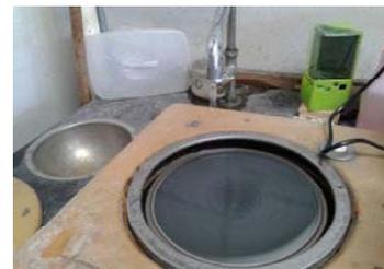
Fig.3 Máquina para limar as pontas da secção
