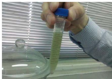
Figura 11 – Tubo de ensaio com amostra e politungostato de sódio
