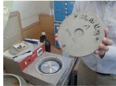
Fig.3 Disco da DP de 3µm
