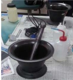
O material que se vai usar na preparação da amostra, deve estar bem limpa e desinfetar com álcool etílico para evitar a contaminação. (Almofariz de ágata, almofariz com pilão, tinas de porcelana, copos de vidro, bacias. Usar, bata, luvas, protetor de som e óculos de proteção.
