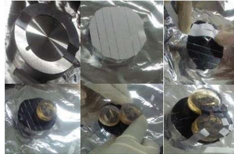
Figura 32 – Preparação e montagem da amostra na porta amostra do SEM.
