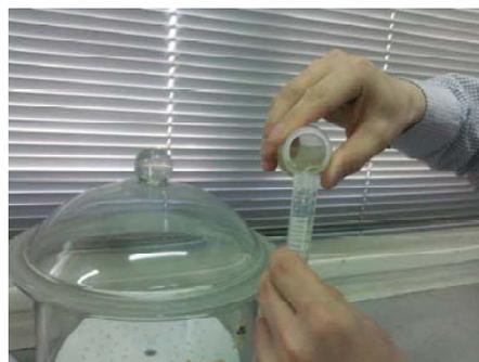
Figura 10 – Introdução do politungostato de sódio no tubo contendo a amostra
