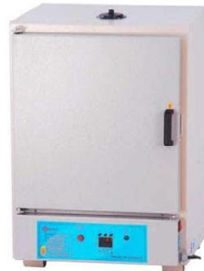
A figura 7, mostra uma estufa para a secagem das amostras. Na figura 6, dentro da tina de porcelana, podemos verificar o material pesado e seco. A amostra com minerais pesados é colocada na estufa, durante 24 horas dia a 60°C
