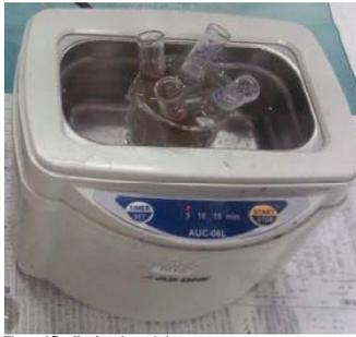
Figura 17 – Banho ultrassônico
