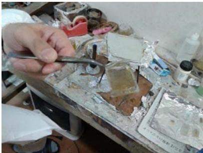
Fig.4 Colagem da lamela
