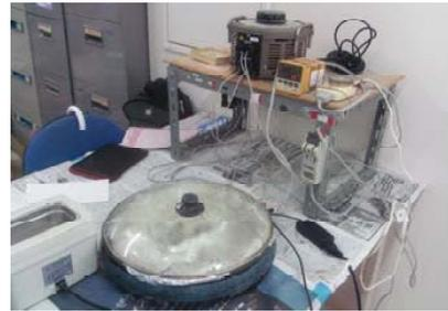
Figura 6 – Processo de secagem da amostra na estufa
