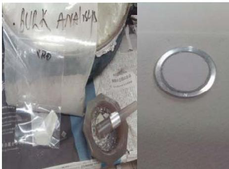
Figura 1 – Preparação de amostras para o XRD
