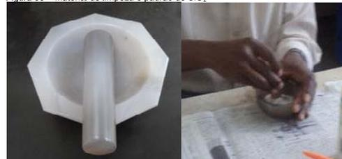
Figura 04 – Preparação de amostras moles – Triturar até o tamanho com a granulometria desejada.
