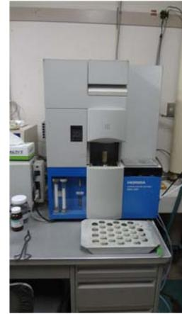
Figura 25. Analisador de Carbono e Enxofre (NDIR) usado no laboratório
