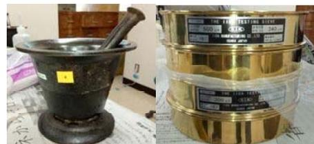
Figura 1: A) "Iron mortar" usado para a trituração da amostra; B) Crivo usado para a separação granulométrica da amostra.
