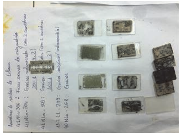
写真 2.3-20 SIDA 供与機材と作成中の薄片（学生実習）
