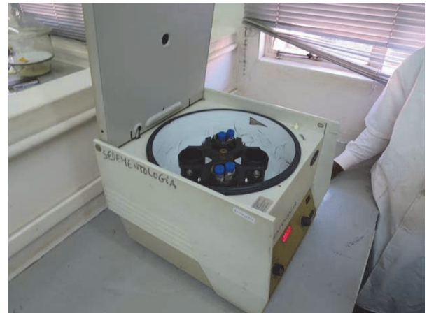
写真 2.3-28 重液 (SPT) の調整及び遠心機による重液鉍物分離
