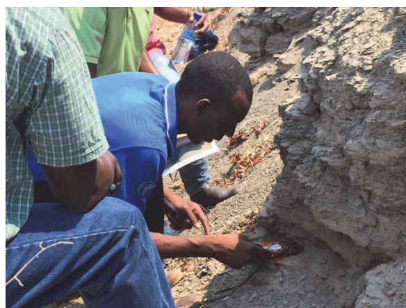
写真 2.6-17 野外実習状況（左：観察方法の説明、右：走向・傾斜計測実習）(6-1)
