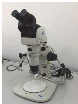
写真 2.2-3 実体顕微鏡（双眼鏡筒）、照明装置（ニコン SMZ1270 TERG-PS32）
