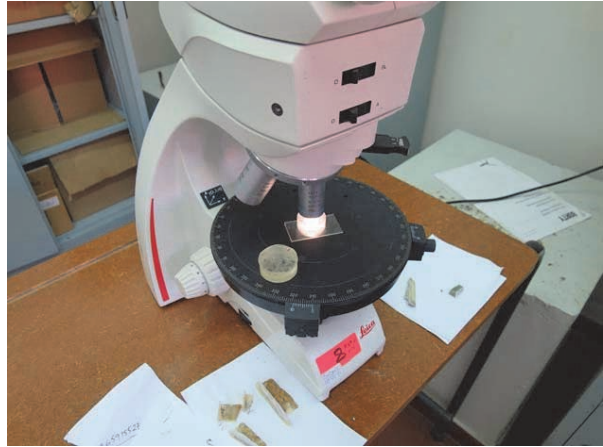
写真 2.3-31 分離されたジルコンの研磨片作成
