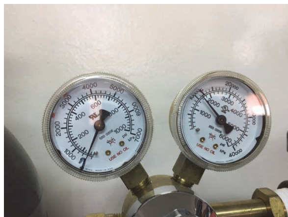
写真 2.3-44 減圧器ゲージ (O 2 ボンベ)
