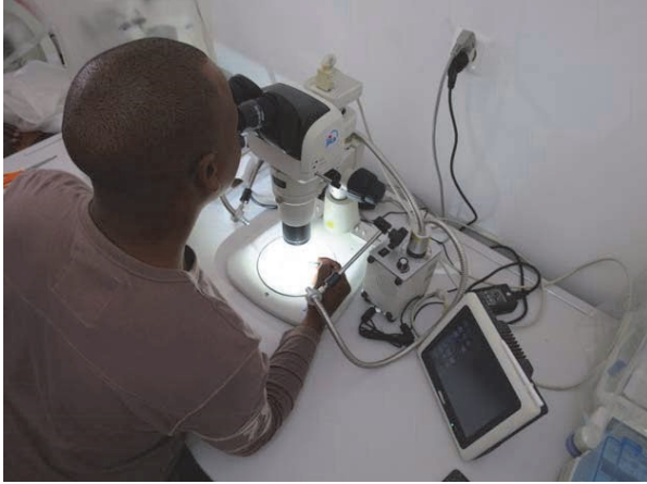
写真 2.3-30 実体顕微鏡によるジルコンの鉍物分離
