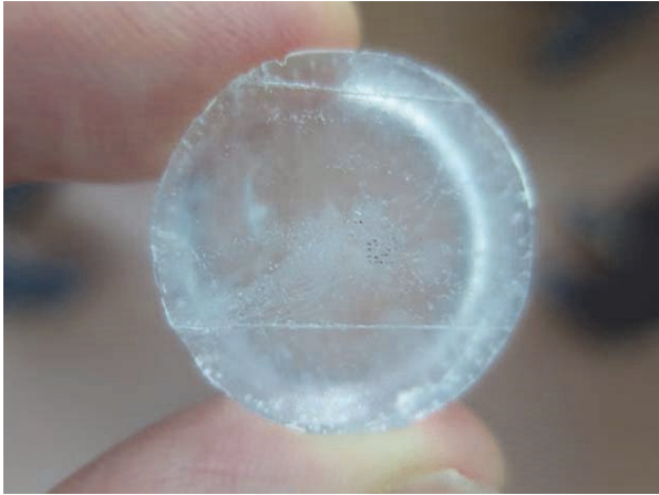
写真 2.3-31 分離されたジルコンの研磨片作成
