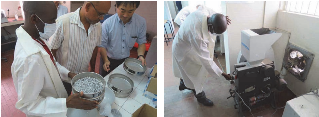
写真 2.3-22 ジルコン分離に係る岩石の粉碎及び篩いによる選別
