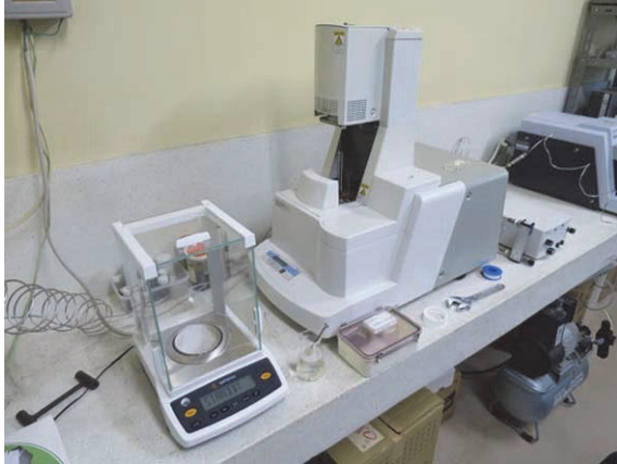
写真 2.3-47 本邦研修での示差熱・熱重量同時測定及び維持管理方法の実習
