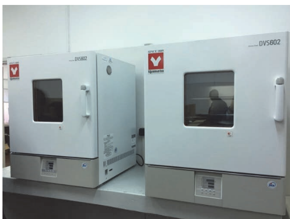
写真 2.2-4 定温乾燥機；2台（ヤマト DVS602）
