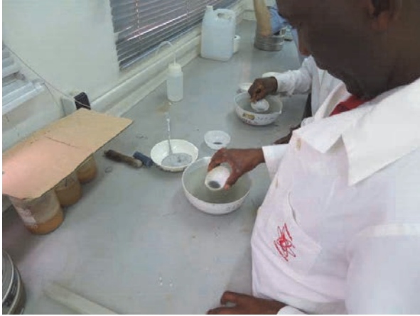
写真 2.3-23 篩により選別された試料の水簸及び乾燥
