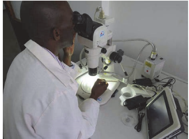
写真 2.3-24 実体顕微鏡によるジルコン分離
