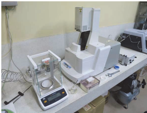
写真 2.3-39 本邦研修での示差熱・熱重量同時測定の実習
