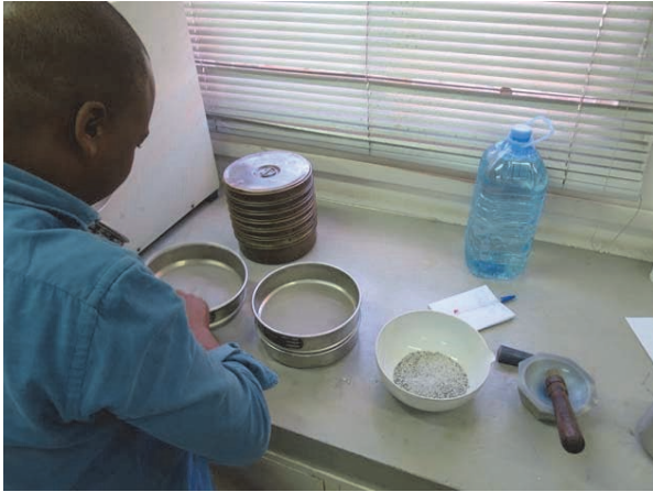
写真 2.3-27 篩及び椀がけによる分離前処理
