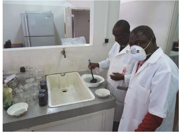
写真 2.3-27 篩及び椀がけによる分離前処理
