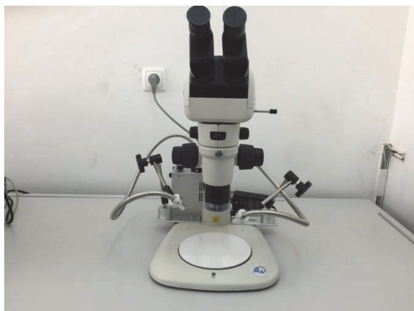
写真 2.2-3 実体顕微鏡（双眼鏡筒）、照明装置（ニコン SMZ1270 TERG-PS32）
