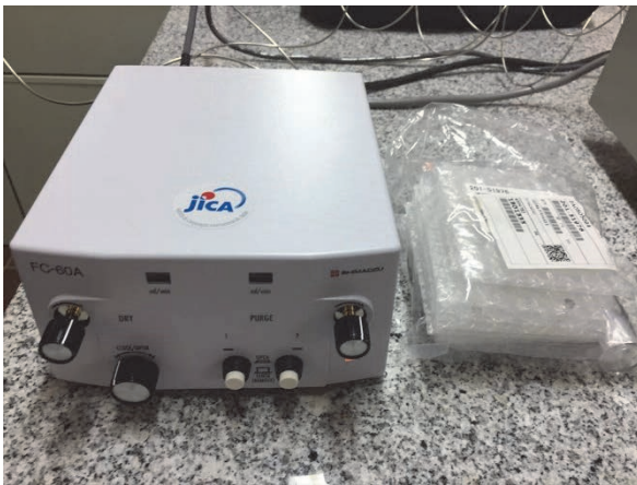
写真 2.2-22 雰囲気制御装置 (島津製作所 FC-60A)
