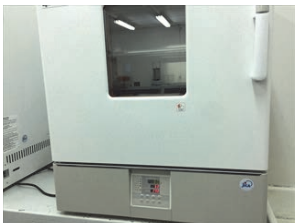
写真 2.3-18 供与機材の使用状況；乾燥機（分離された粘土鉱物の乾燥）
