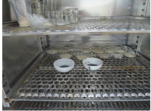
写真 2.3-23 篩により選別された試料の水簸及び乾燥
