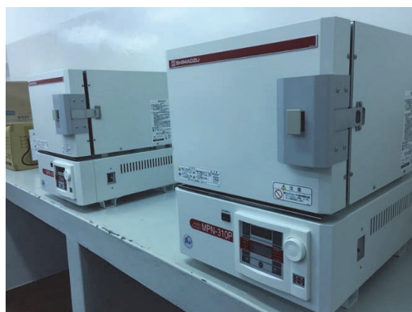
写真 2.2-5 電気マッフル炉；2台 （島津理化 MPN-310P）
