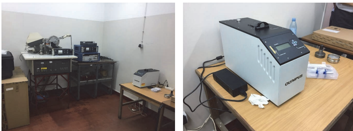
写真 2.3-7 新設された粉末 X 線回折装置設置状況（UEM 地質学科内）
