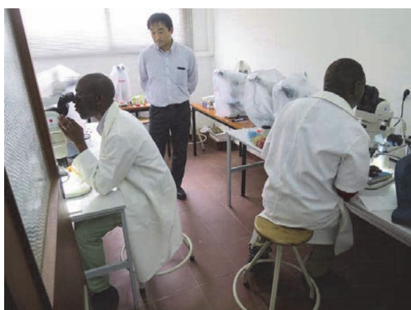
UEMにおける実体顕微鏡を利用した岩石からのジルコン抽出方法の指導状況
