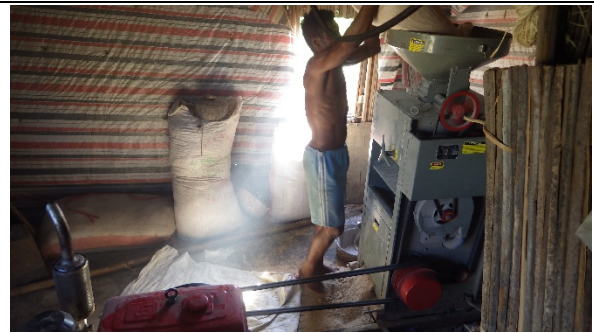
8) Décortiqueuse de type enveloppes-grains (un passage) diffusée dans tout le pays. L'apparition d'un appareil à prix raisonnable a fait augmenter le nombre des petites entreprises de décorticage. District de Morovoay, région de Boeny.
