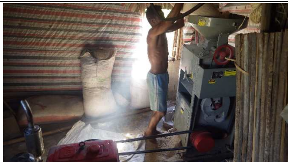
8) 全国で広く普及している粳摺・精米一体型（ワンパス）精米機。安価な機械の登場により、小規模精米業者が増加している。Boeny 県 Marovoay 郡
