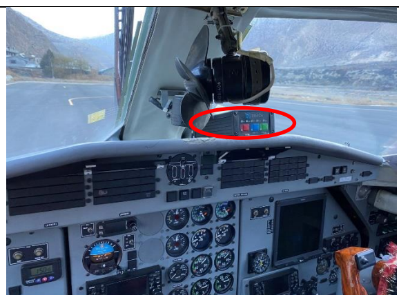
写真 3.3-9 Summit Air の L410 コックピット内に設置されている V2 Tracker の発信機
