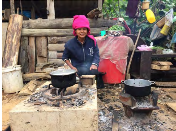
コンクリート製改良かまど（左）とラオストーブ（右）
