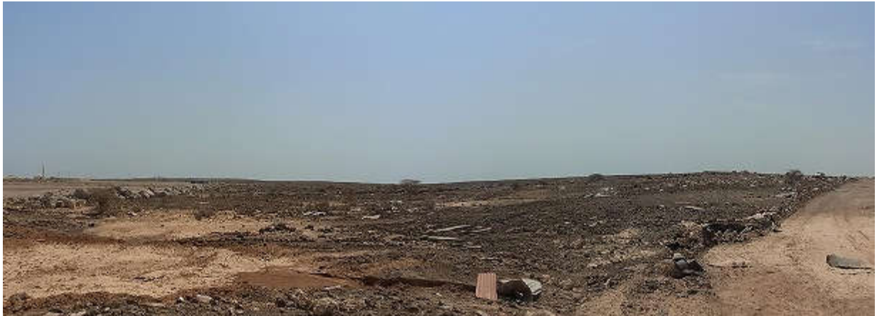
写真 1: 計画地の現況(2019年6月)。裸地であるが大小の転石が点在し、表面に露出した大きな岩も確認できる。最大2%程度の緩やかな勾配がある土地で、所々に僅かな灌木が見られる。
