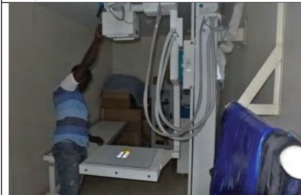
X線：2013年に Welbodi Partnership より供与されたコンテナ格納式一般X線撮影装置（デジタル管理）
