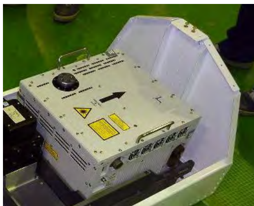
図 3-8 レーザ測距装置 (ALTM Orion M300) 及びデジタルカメラ (Phase One IXU-RS-1000) の例
