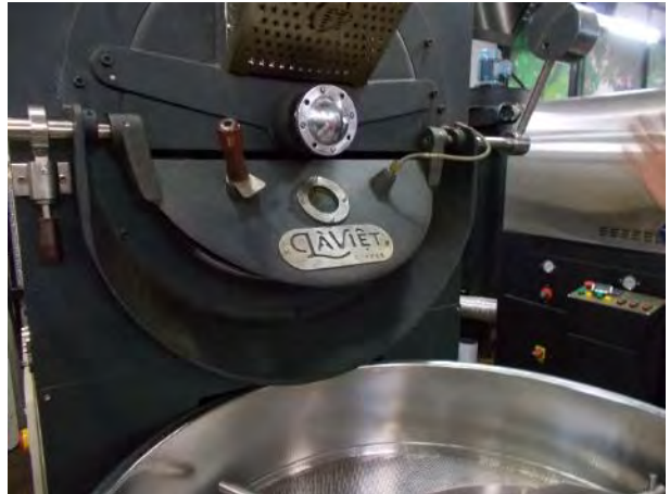
コーヒー豆焙煎機（特注機材） / Coffee bean roaster (specially ordered) (La Viet Co., Ltd)
