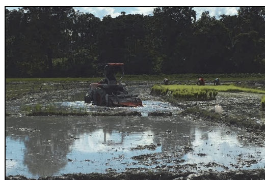
ロータリーを装着して水田で代掻き中の 34ps クラスのクボタ製トラクター (サルパン県ゲレフ地方)
