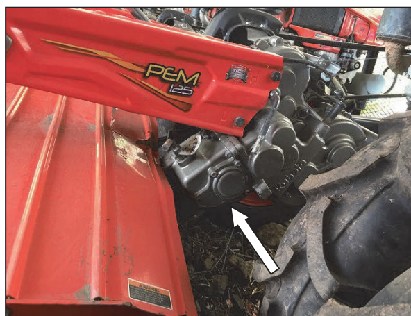
ダイレクトギア駆動方式 Phase1 プロジェクトで調達機材
