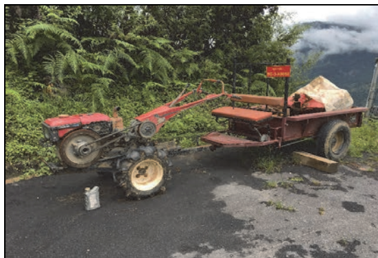
耕耘機にトレーラーを装着した状態 小型耕耘機はトレーラーを牽引できない
