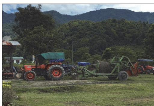
ストーンピッカーを牽引している 75ps クラスのクボタ製大型トラクター (サルパン県ゲレフ地方)
