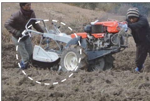
ロータリーによる破土・均平作業
