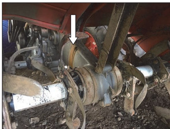
ロータリー回転刃とギアボックスケースの干渉
