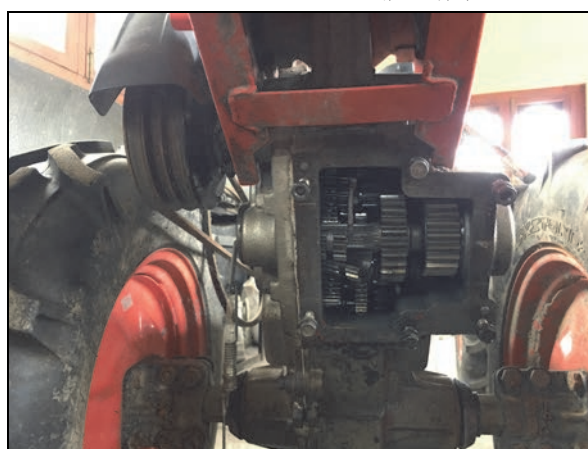
ダイレクトギア駆動方式ではロータリー取外し時 接合部がオープンになりギヤオイルが流出する
