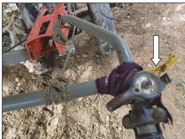
切断したスロットルケーブル
