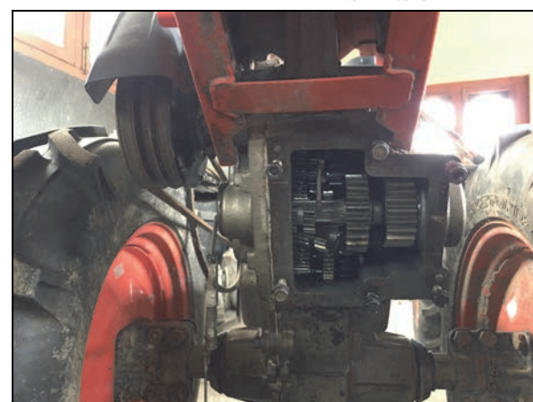
ダイレクトギア駆動方式ではロータリー取外し時 接合部がオープンになりギヤオイルが流出する
