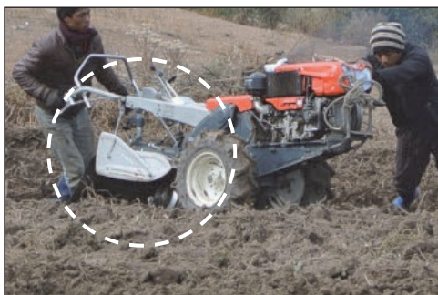
ロータリーによる破土・均平作業
