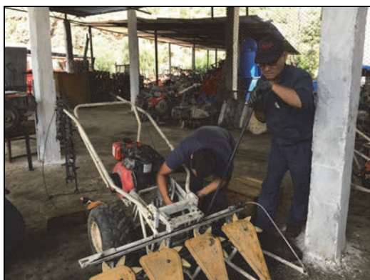
刈取り機（稲の刈取り専用機械）が RFMCL に配備されている（バジヨ支所）
