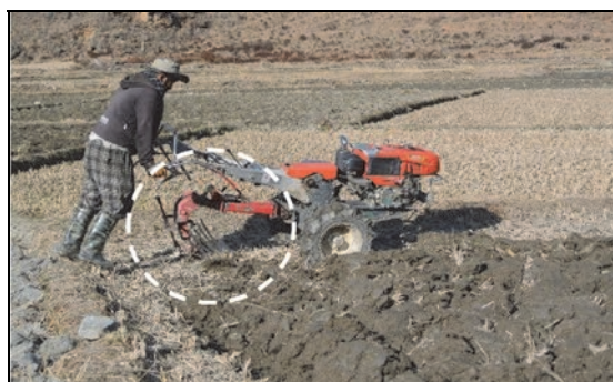
土地造りのための耕起 (Plowing)、シングル・リバーシブルプラウを使って掘り起こす
