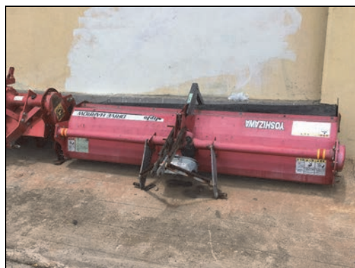
トラクター用のロータリー 耕耘機に比べ一度に広い範囲の耕作作業を行うことが可能
