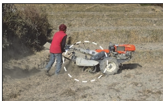
耕起後の耕耘 (Rotovating)、掘り起こした土をロータリーで破土し平らに均す
