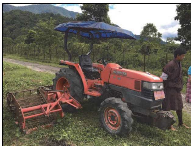
経年劣化によりキャノピーの損傷、さび等若干の損傷があるが運用上問題ない (サルパン県 Gelephu)
