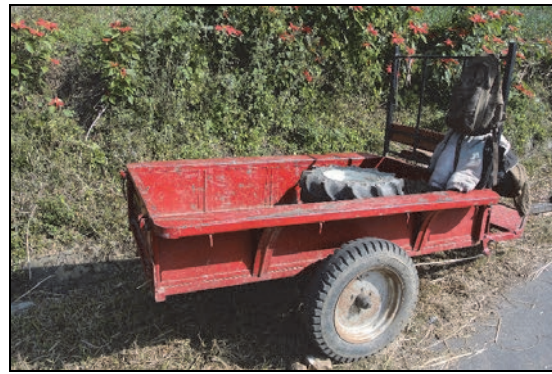
耕耘機で牽引してきたトレーラーは圃場近くに駐機する。トレーラーにはロータリーなどを積載し圃場で耕耘機に装着する。
