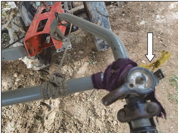
切断したスロットルケーブル
