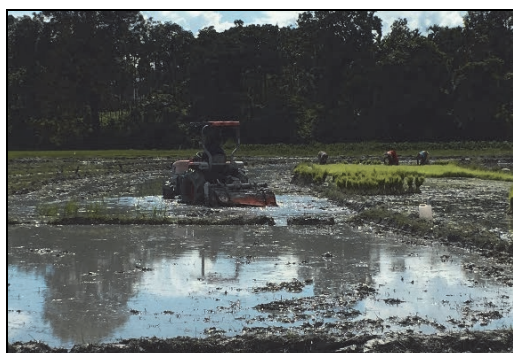
ロータリーを装着して水田で代掻き中の 34ps クラスのクボタ製トラクター (サルパン県ゲレフ地方)
