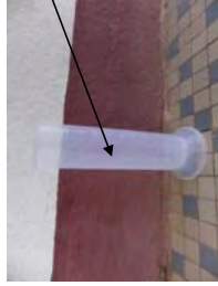
“Proveta para medição da precipitação para 200 \text{cm}^2 ”
