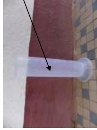
“Proveta para medição da precipitação para 200 \text{cm}^2 ”
