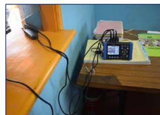
Fig. 3-9 Verificação do fornecimento de energia eléctrica nas instalações do radar de Xai-Xai
