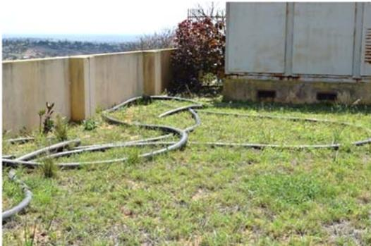
地中から取り出した旧電源ケーブル、ケーブル内部で芯線が短絡していた模様
