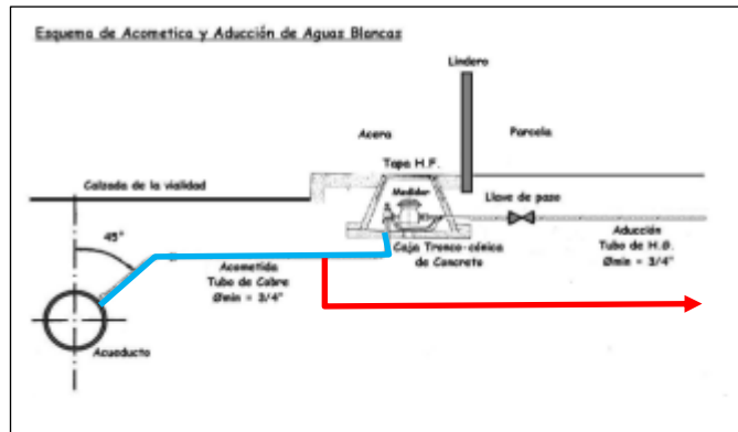
Figura 3.2 Imagen general de una conexión ilegal
