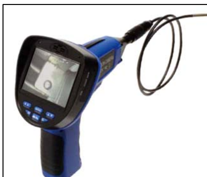
Fotografía 3.8 Endoscopio industrial utilizado
