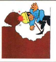
Figura N° 10. Prohibición de la socavación.
