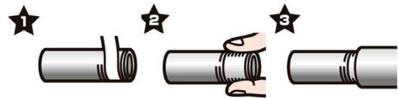
Figura N° 27. Conexión de tubo de PVC (conexión roscada).
