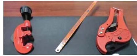
Figura N° 20. Herramientas de corte para tubos de PVC.
