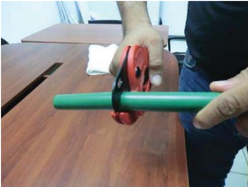
Figura N° 23. Corte del tubo de conexión domiciliaria (polietileno).
