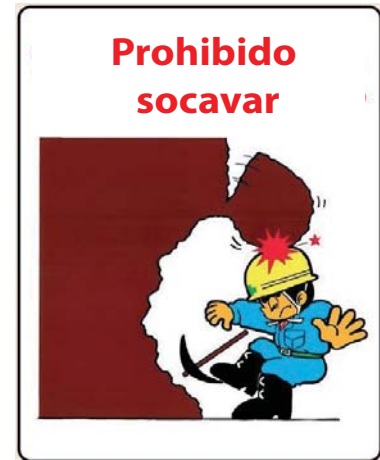
Figura N° 10. Prohibición de la socavación.
