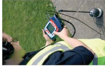
Figura 3.5 Modo de uso del geófono electrónico localizador de fugas
