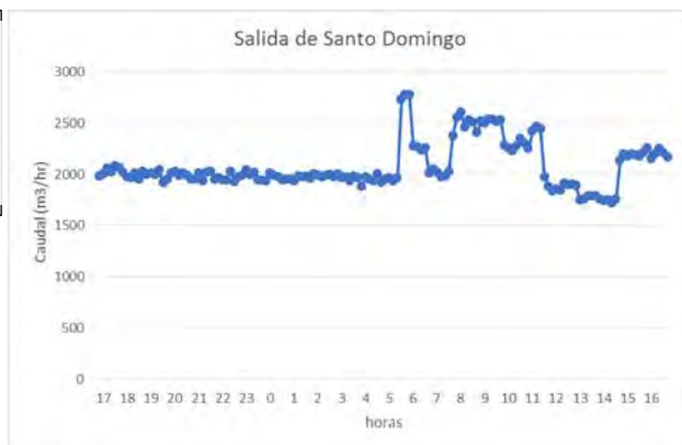
Figura 2.1.10 Caudal de agua de entrada y salida del Tanque Santo Domingo
