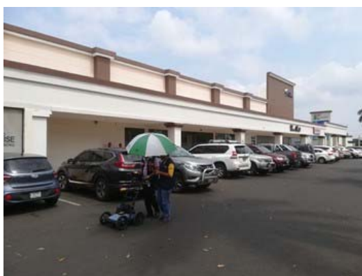
P-3 地中レーダー探査機を用いた調査
