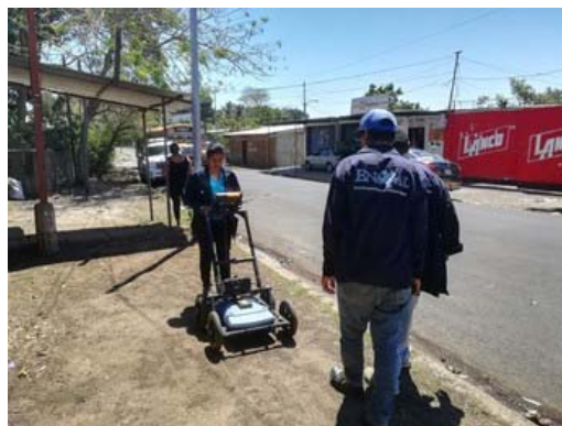
P-4 地中レーダー探査機を用いた調査
