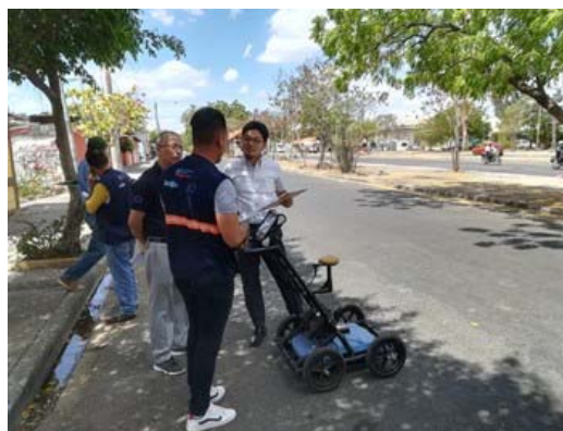
P-2 地中レーダー探査機のトレーニング
