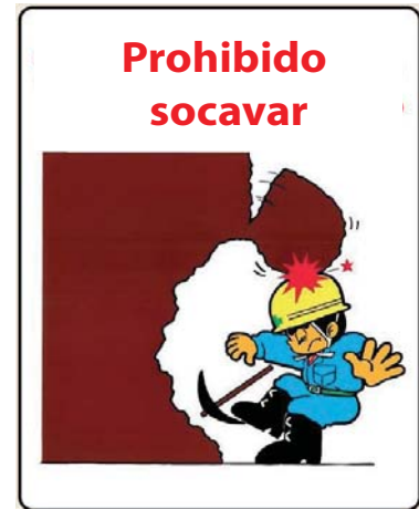
Figura N° 10. Prohibición de la socavación.
