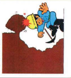
Figura N° 10. Prohibición de la socavación.
