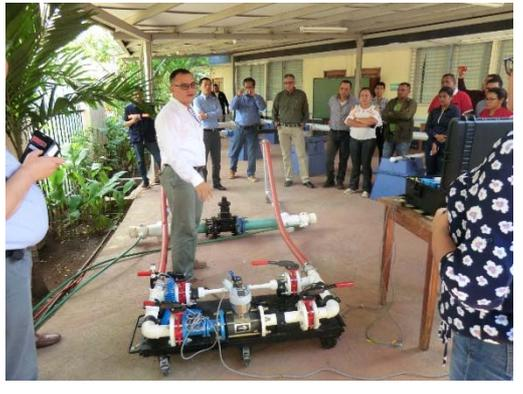
セクター漏水量の直接測定システムの実演
