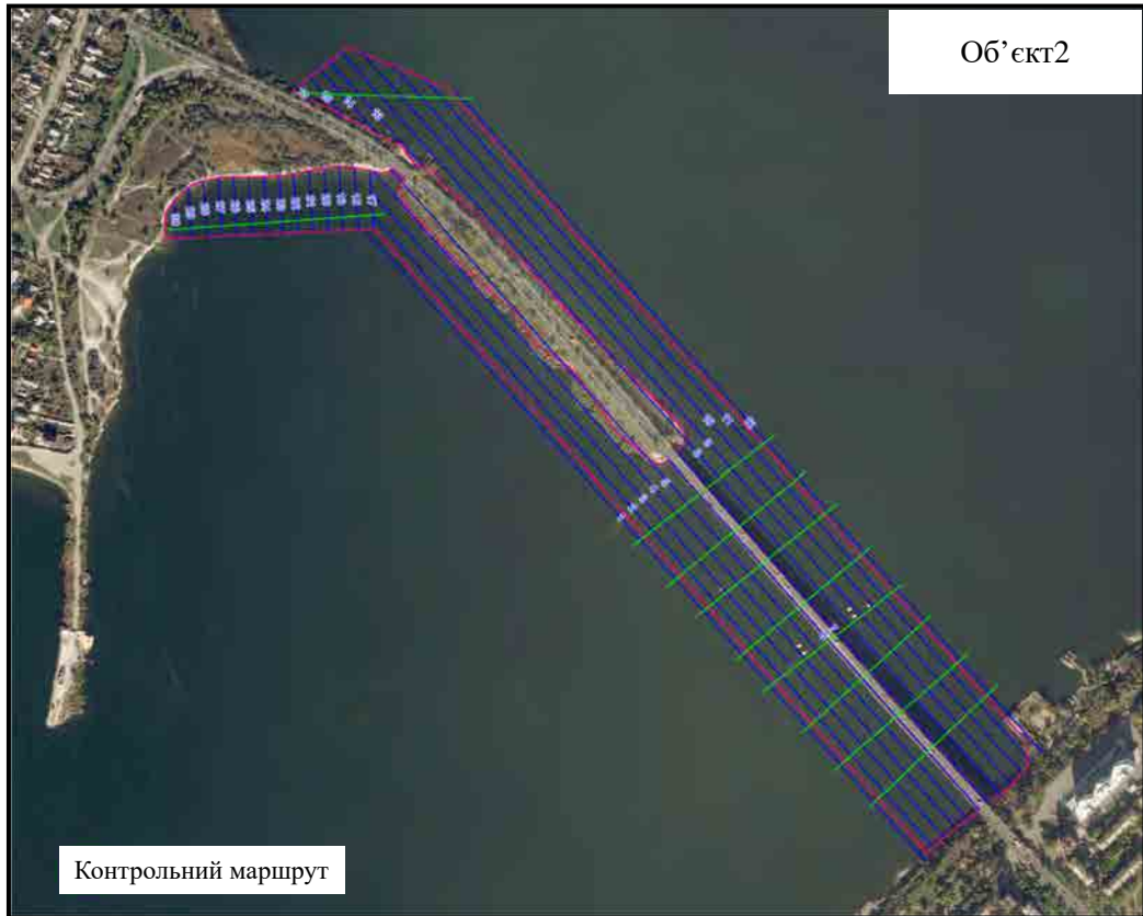
Рисунок 4-2-5. Схема ліній маршруту зйомки батиметрична зйомка)
