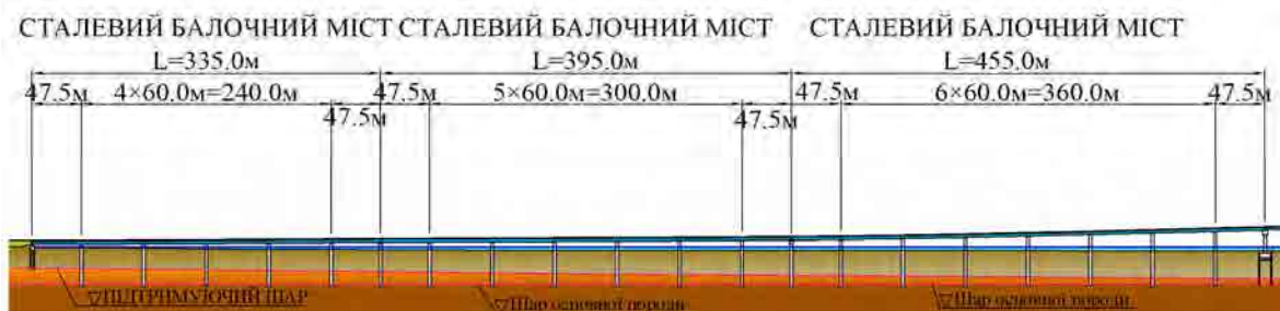
Рисунок 7-6-3. Схема розміщення під'їзного мосту на лівому березі (маршрут 2)
