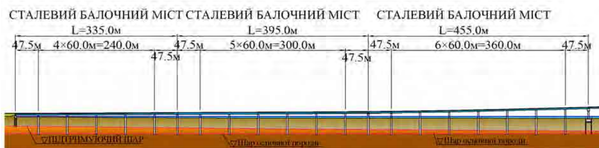
Рисунок 7-4. Схема розміщення під'їзного мосту на лівому березі (маршрут 2)
