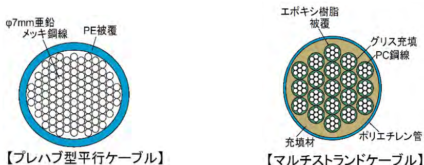
図 7-10-5. 高品質斜材ケーブル
