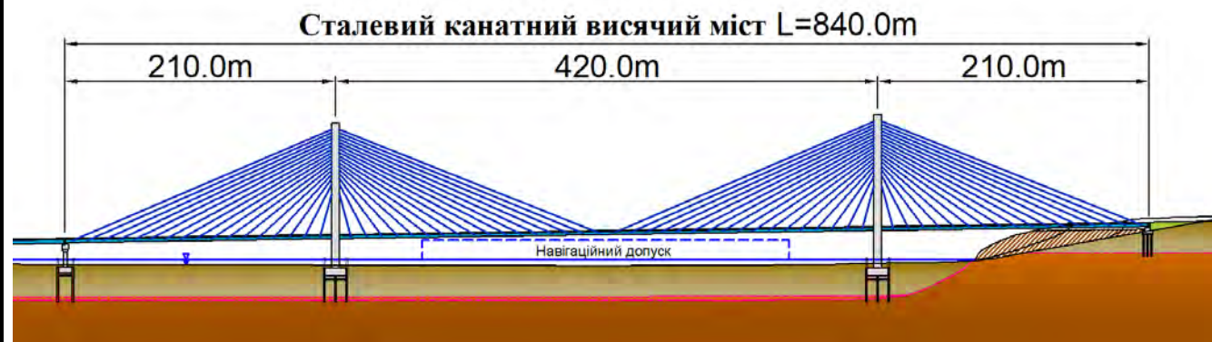
Таблиця 7-9-8. Розріз головного мосту: Таблиця порівняння типу мосту (1/3) (маршрут 3)
