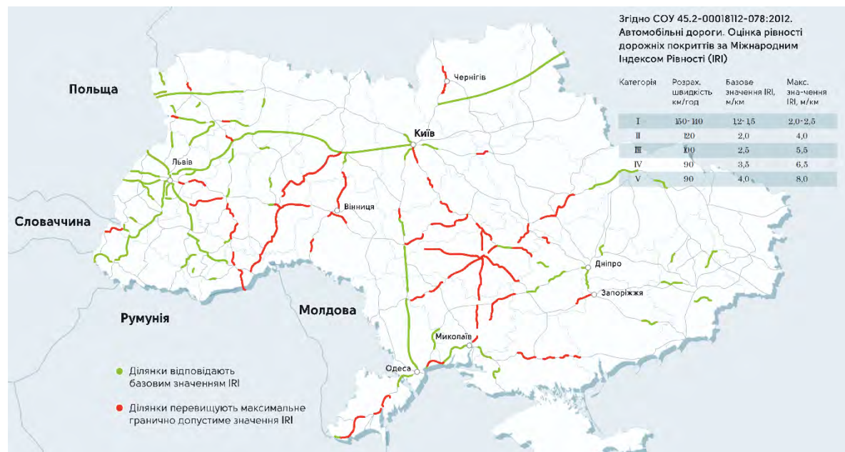
Рисунок 1-6-2. Оцінка рівня дорожнього покриття за міжнародним індексом рівності (IRI)
