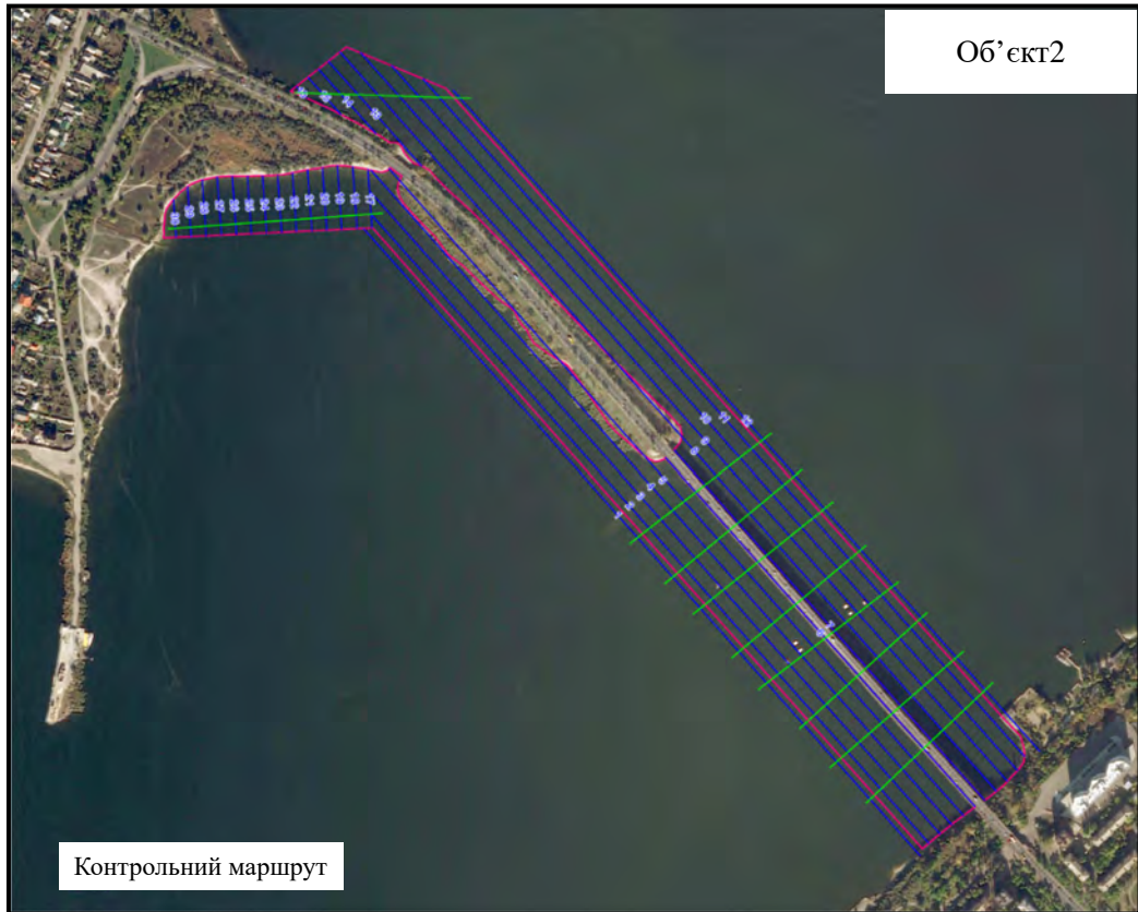
Рисунок 4-2-5. Схема ліній маршруту зйомки батиметрична зйомка)
