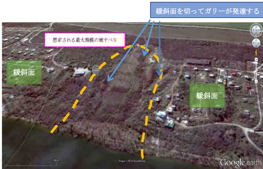
図 9-4-2. ルート 2 右岸ブロック写真 (Google earth による画像に調査団加筆)
